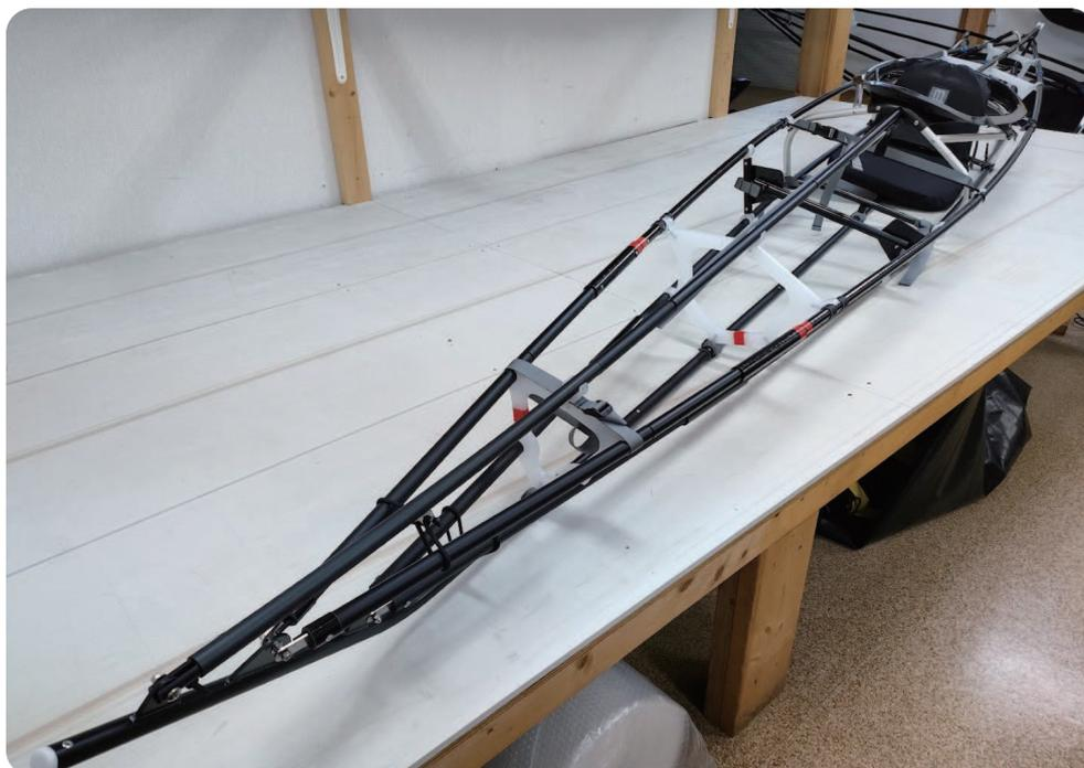
クルーソー LITE は背負えるバックパックに収納するシングル艇で、シーソックは付属せず、車軸差し込みができない以外は XPOD と同じフレームです。収納時はコックピット部分を上下に分離するため、XPOD よりもコンパクトになります。オプションのシーソックなどを後付けすることで、XPOD のように使用することもできます。
