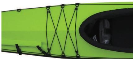
コックピット前のバウデッキ部分のDリング間に、さらにDリングを追加したり、標準ではロープ通し用ループだけの部分にDリングを入れたりすることにより、ショックコードをさまざまな配置に出来るオプションです。
