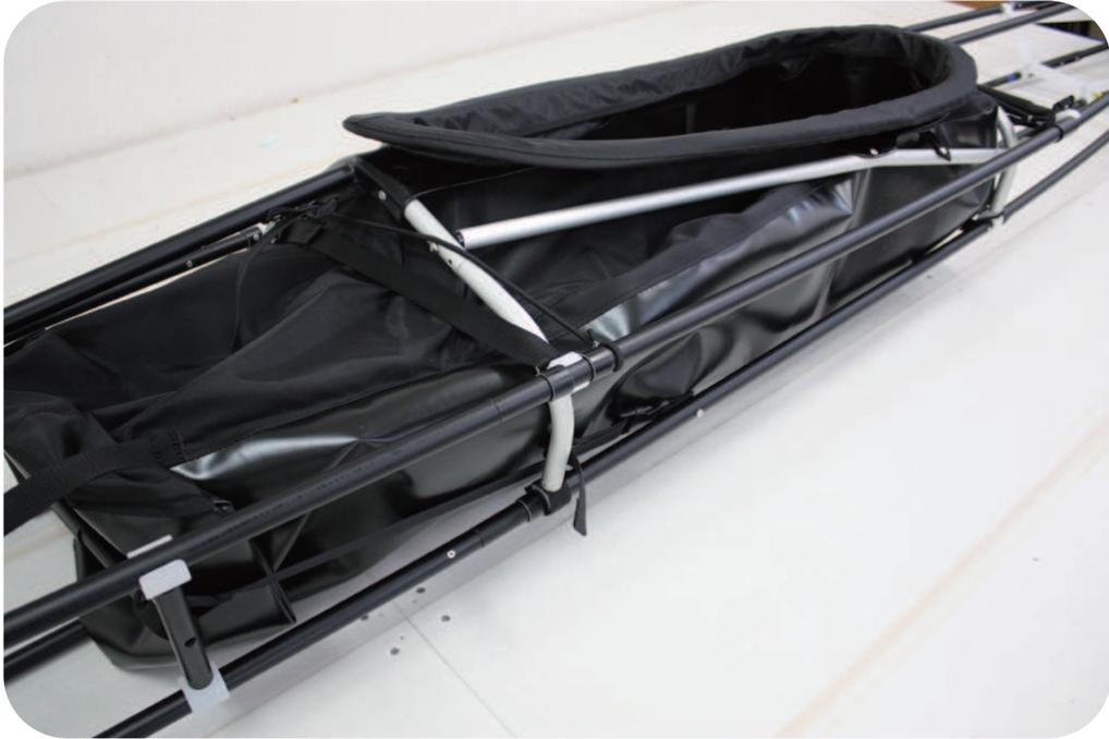
クルーソー XPOD は沈脱時、船体内への浸水を最小限に抑え浮力を確保するシーソックがそのまま収納バッグになり、コックピット部分は組み立てたまま、その中に全ての部品を収納するシンプルで安全性の高いコックピットポッドシステム採用のシングル艇。シーソックの素材には1000D ポリエステルPVC ターポリンを溶着接合した完全防水素材を使用し、長期の使用にも耐えます。オプションでさらに丈夫なTPU素材や軽量のナイロン素材への変更も可能。また、コックピットポッドの骨格にはFRPコーミング+高強度アルミ曲げパイプを組み合わせた一体構造を採用し、軽くて高剛性なコックピット周りを実現しました。また、その強度を生かして、車輪をコックピットに差し込むだけで高剛性なカートバッグになります。オプションのバックパックを利用すればLITEのようにコンパクトに収納することもできます。
