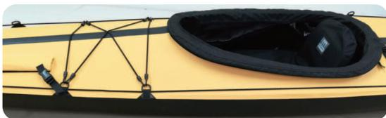
デッキ中央にセンターラインを溶着接合します。引き締まったデザインになり、デッキ布の補強にもなります。黒以外の特別色でも同価格で製作可能です。
