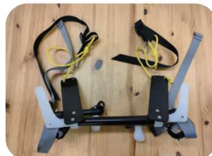
グラスファイバー製CNC切り抜き板を使用したラダーセット。フットペダルは回転式でラダーを上げている時もしっかりと踏み込むことができます。後付けの場合、ご自身で船体布にポンチで穴あけをするか、船体布を送っていただく必要があります。
