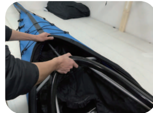
④フレームを船体布に差し込む
