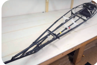
③バウ、スターン、リブフレームの取付
