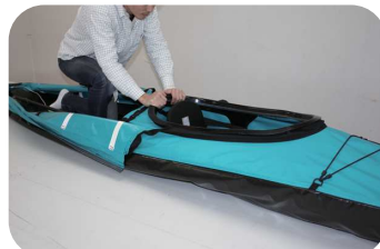
④船体布にフレームを押し込む
