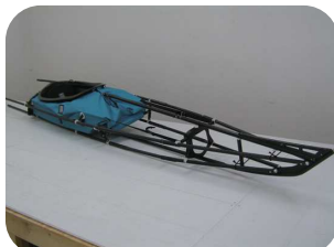
③バウ側フレームを取り付ける
