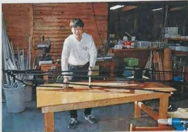
カヤックの骨組みをつくる高嶋さん。骨組みはFRP製が中心
